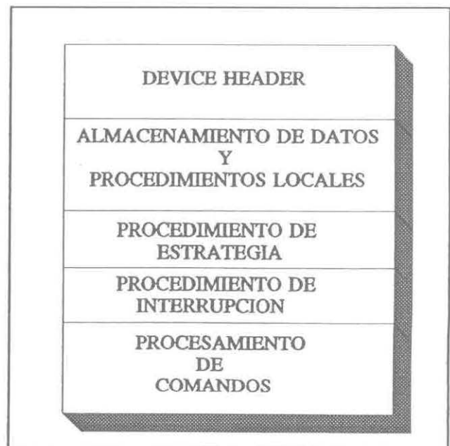
FIGURA IV-3. PARTES BASICAS DE UN DEVICE DRIVER.
