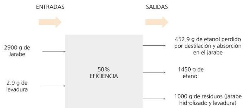
*Figura 19. Proceso de entradas y salidas en la conversión de etanol basado en tanque de 10 litros.*
