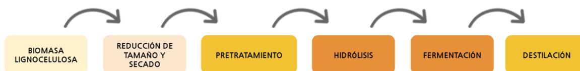
*Figura 18. Proceso para la generación de etanol de lignocelulosa.*
