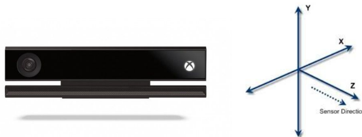
Figura 34. (A) Kinect v2 (B) Sistema de coordenadas del sensor.
