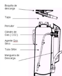
EXTINTOR DE: POLVO QUIMICO SECO CON CARTUCHO EXTERNO DE CO2
