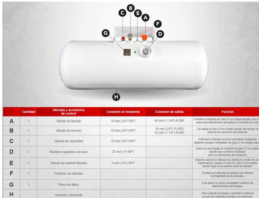
Ficha técnica del tanque de carburación
